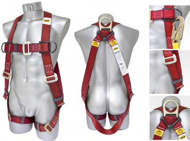
Arnés con anillo "D" en la espalda. Al sufrir una caída el arnés de cuerpo completo distribuye la fuerza que se aplica en el cuerpo del trabajador en los glúteos, hombros, pecho y torso. Fabricado en banda de 13/4 de ancho. Anillo "D" deslizable en la espalda. Correas de pecho y piernas ajustables. Hebillas de rápida conexión. Disponible con hebillas de machuelo y de seguridad QR. Correa de pecho ajustable en altura. Correa subpélvica.
